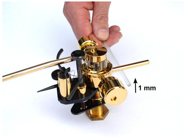
Fig. 7. En soulevant la tige du contrepoids de 1 mm, les poids des deux côtés doivent se soulever simultanément.
